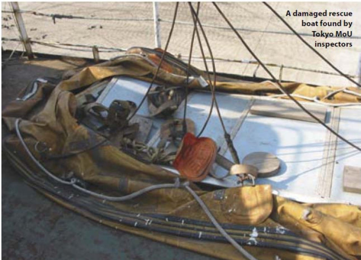
東京MoU検査官により発見された 壊れた救命ボート
