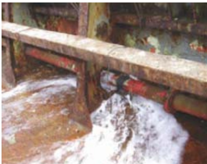
東京MoU検査官により発見された更なる欠陥: 腐食し穴のあった消火用のパイプ
