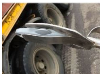
RFIDタグ設置治具
