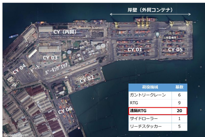
図 3.18 タンジュン・エマス港における遠隔操作 RTG の導入状況
