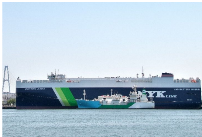
写真 Ship to Ship 方式による LNG 燃料の供給
