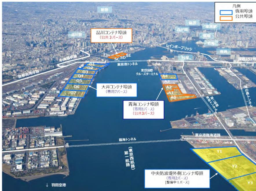
東京港では、近年のコンテナ船の大型化の進展及びコンテナ貨物量の増加に対応するため、中央防波堤外側に外資コンテナ埠頭の整備を進めています。平成29年11月1日にY1ターミナルが、令和2年3月23日にはY2ターミナルがそれぞれ供用を開始しています。現在、新たにY3ターミナルの整備を進めており、令和9年度（2027年度）中に完了する予定です。その後、Y3ターミナルを種地として、大井埠頭の再編整備に着手していきます。
