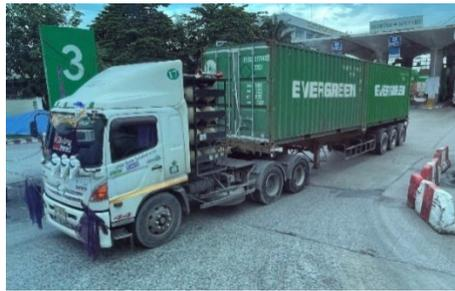
図 4-10 CNG トラクター
