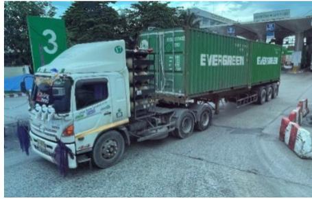
図 4-10 CNGトラクター
