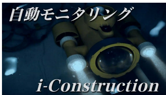
図 6.1.6 無人潜水艇を用いた点検
