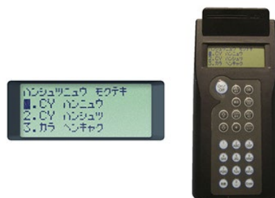
図 4.2.6 RFID (Radio Frequency Identification=多機能 ID ログ)
