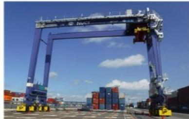
遠隔操作化・自動化するRTG (合計40基)
