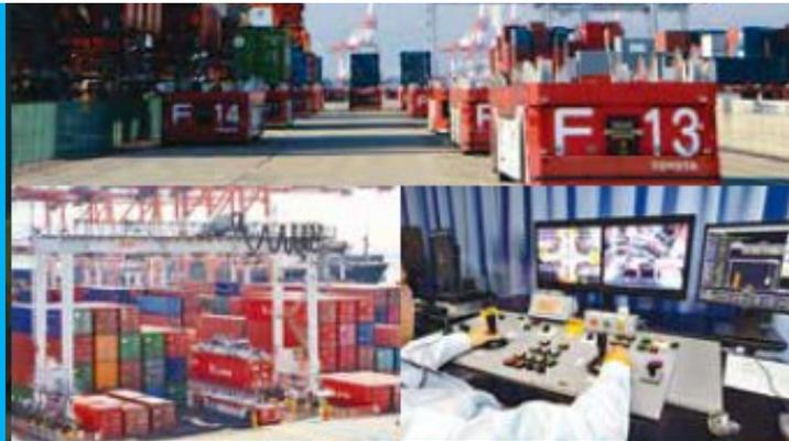
ガントリークレーンとヤード間を自動制御で往復する自動搬送台車(AGV)を導入。遠隔自動RTGとの連携により荷役作業の更なる効率化が図られています。
