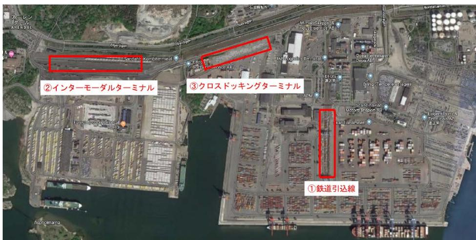
図 3. 1 コンテナターミナルの引込線
