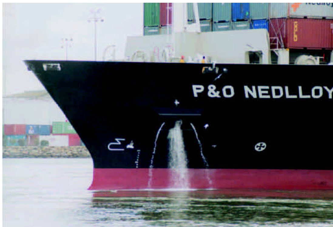
写真提供 Dale Crisp: コンテナ貨物積載後バランスを取る為バラスト水を排出している P & O ネドロイド船
