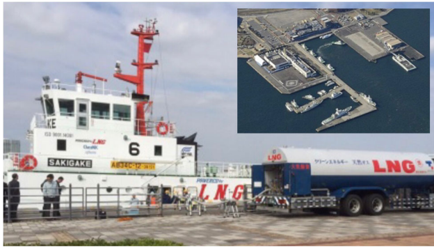
図 5-10(左) 新港ふ頭における「魁」へのLNGバンカリング
