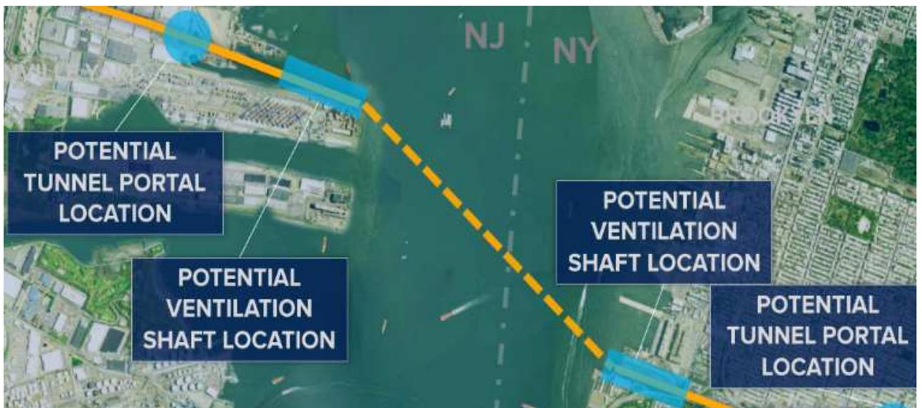
図-19 Tier2 で評価されるダブルスタックレールトンネル案
