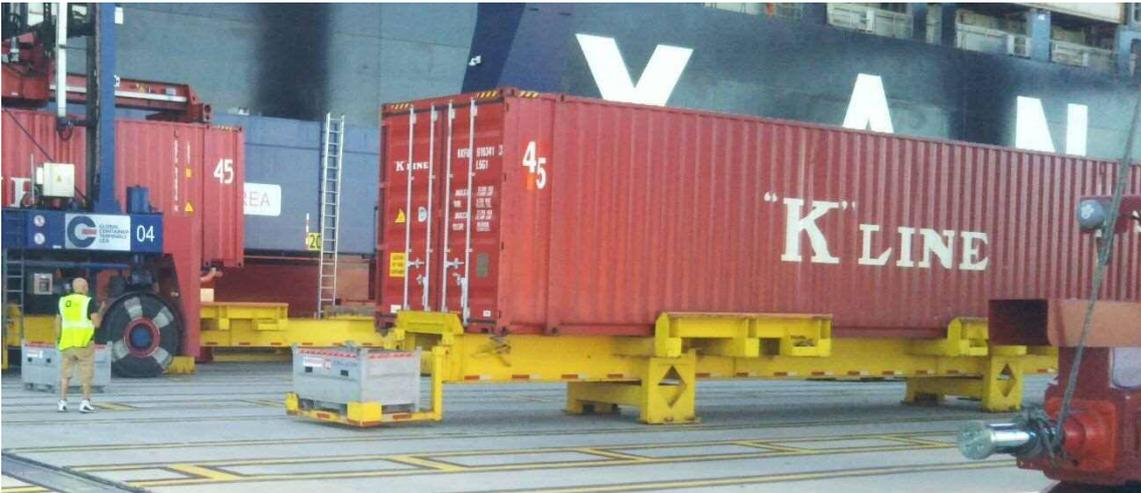
図28 コンテナのスタッキングコーン脱着用の受け台
