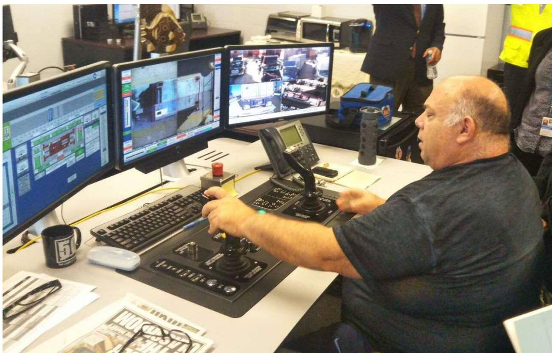
図30 ASC 遠隔操作の操作卓
