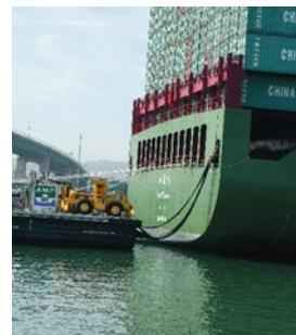
コンテナ船の荷役係留時間は3日～4日と長いいため、燃料油に比べ経済効果は高く、経費の節減にも寄与し、2016年段階で全ターミナルの72%でAMPの設置が完了している。
