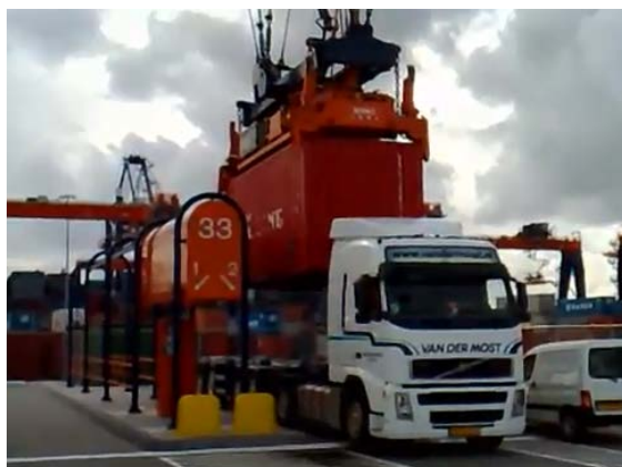
外部トレーラーへのコンテナ積込作業
