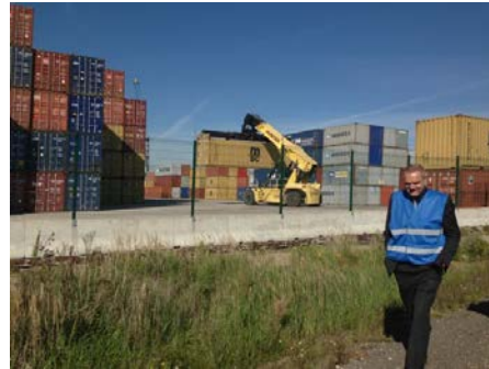
(写真 2) リーチスタッカーによる構内荷役
