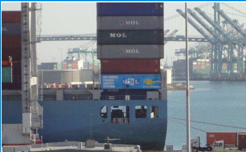
写真1 AMP専用コンテナを積載し陸上から電力供給している船舶の様子 (撮影:2012年10月2日 TRAPACターミナルにて)
